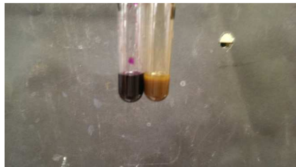
Abb4. – links: Bromwasser mit (l) und ohne (r) Ethen, rechts BAYERS Reagenz mit (r) und ohne (l) Ethen
