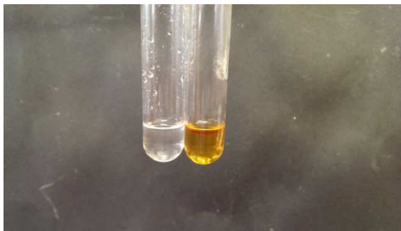
Abb4. – links: Bromwasser mit (l) und ohne (r) Ethen, rechts BAYERS Reagenz mit (r) und ohne (l) Ethen
