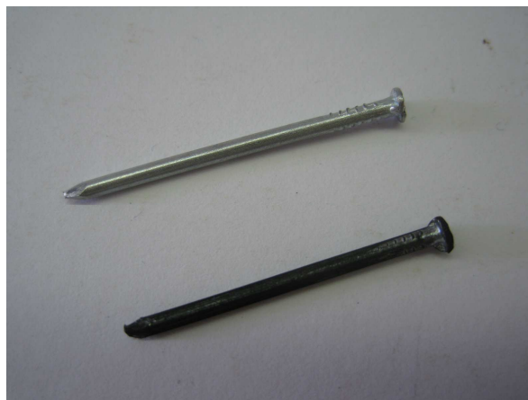
Abb. 2 – Beobachtung des Versuchs „V2“. Oben: Nagel vor der Versuchsdurchführung. Unten: Nagel nach der Versuchsdurchführung (mit dunkler Schicht überzogen).
