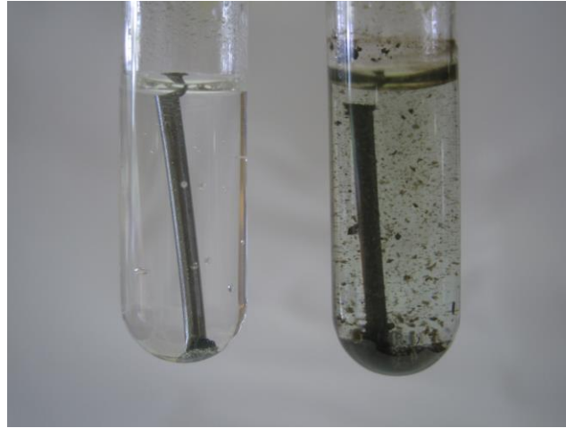
Abb. 4 – Beobachtung Versuch „V4“. Links: Eisennagel mit Zink-Granulat. Rechts: Eisennagel ohne Zink-Granulat.
