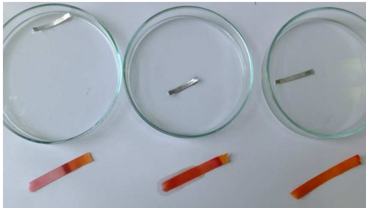
Abb 1: Reaktion von Methan-, Ethan-, Propansäure (von links) mit Mg-Band und Indikatorpapier
