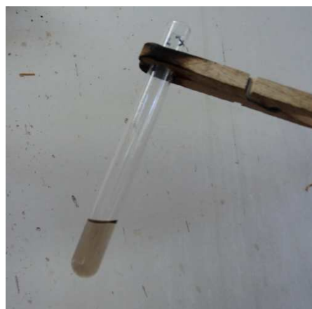
Abb. 6 - Naphthalin und konzentrierte Schwefelsäure nach dem Erhitzen
