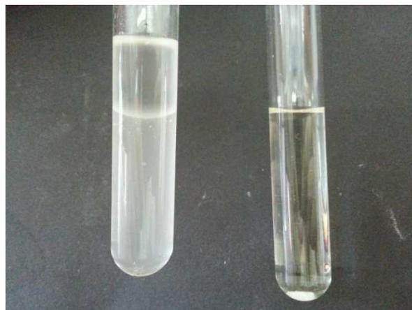
Abb. 2 - Toluol mit Bromwasser und Naphthalin-Lösung mit Bromwasser nach der Belichtung
