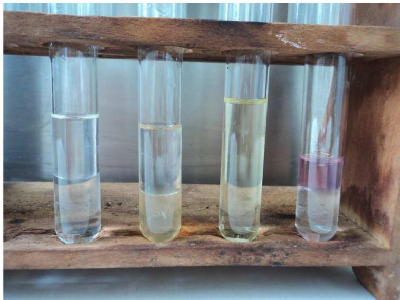
Abb. 1 - Hex-1-en mit Brom und Bayer-Reagenz, Naphthalin-Lösung mit Brom und Bayer-Reagenz
