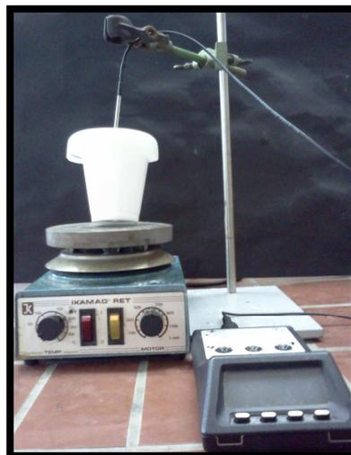
Abb. 2 – Versuchsaufbau „Kalorimetrie“
