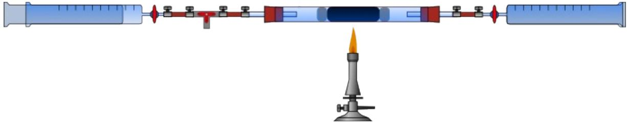
**Aufgabe 1:** In einem Kolbenprober befinden sich 30 ml Stickstoff und 10 ml Dampf einer organischen Flüssigkeit. Das Gemisch wird mit einem zweiten Kolbenprober mehrfach über erhitztes CuO geleitet. Dieses verfärbt sich an einigen Stellen von schwarz nach kupferfarben. Das Volumen der Gasphase erhöht sich bis auf 48 ml.
