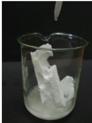
Abb. 5 – Beträufeln von Styropor mit Aceton
