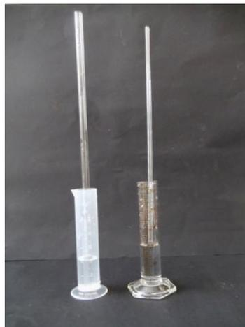
Abbildung 2: Einstellung des dynamischen Gleichgewichtes. Links Messzylinder A (Edukt), rechts Messzylinder B (Produkt).
