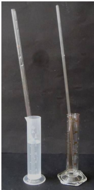
Abbildung 1: Versuchsaufbau für den Modellversuch „Chemisches Gleichgewicht“.
