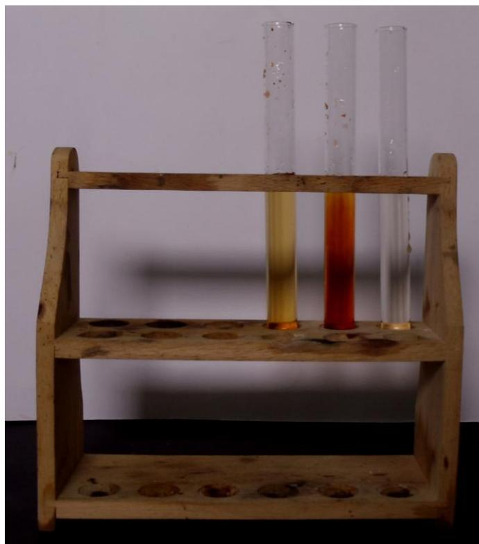
Abbildung 2: Die Lösung verfärbt sich wieder rot-braun bei Zugabe von Ammoniumthiocyanat (in der Mitte) und gelb-rötlich bei Zugabe von Eisen(III)-chlorid. Rechts die Blindprobe.
