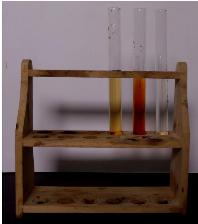
Abbildung 12: Die Lösung verfärbt sich wieder rot-braun bei Zugabe von Ammoniumthiocyanat (in der Mitte) und gelb-rötlich bei Zugabe von Eisen(III)-chlorid. Rechts die Blindprobe.
