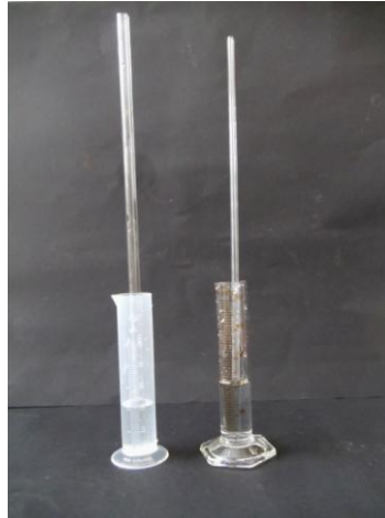
Abbildung 10: Einstellung des dynamischen Gleichgewichtes. Links Messzylinder A (Edukt), rechts Messzylinder B (Produkt).
