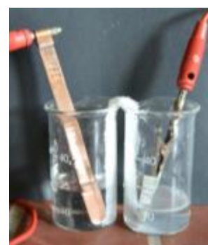
Abbildung 1: Aufbau der beiden Halbzellen. Hier am Beispiel von dem Kupferblech mit dem Magnesiumblock.
