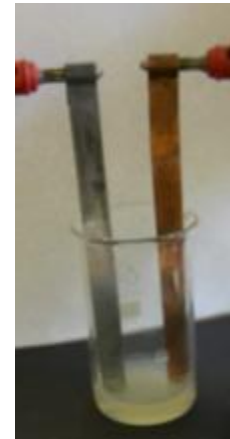
Abbildung 1: Zink- und Kupferelektrode im Zitronensaft.
