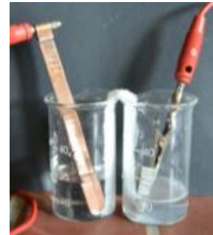
Abbildung 3: Aufbau der beiden Halbzellen. Hier am Beispiel von dem Kupferblech mit dem Magnesiumblock.
