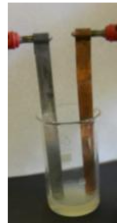
Abbildung 4: Zink- und Kupferelektrode im Zitronensaft.
