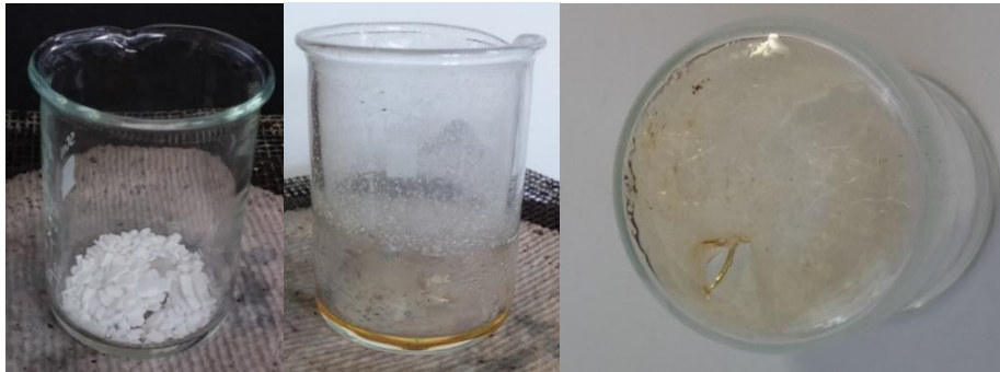
Abb. 5 - Phthalsäureanhydrid mit Glycerin vor, nach dem Erwärmen und nach dem Aushärten.
