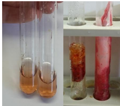
Abb. 6- Resorcin und Formaldehyd vor und nach der Kondensation. Auf dem rechten Bild ist links die Kondensation mit Natronlauge als Katalysator, rechts die Kondensation mit Salzsäure.
