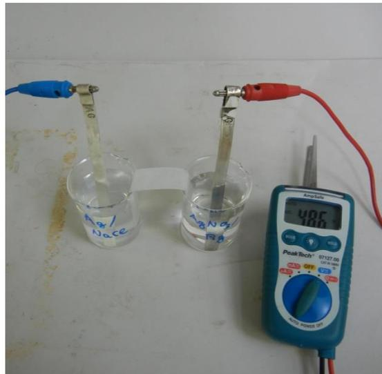
Abb. 1: Versuchsaufbau der galvanischen Zelle. Links die Anode mit der Natriumchloridlösung und rechts die Kathode mit der Silbernitratlösung.
