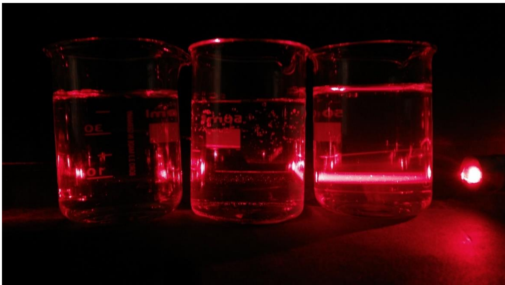
Abb. 1: V.l.n.r.: Destilliertes Wasser, Natriumchlorid-Lösung, Eiklar-Lösung. Nur in der Eiklar-Lösung wird der Lichtstrahl sichtbar.
