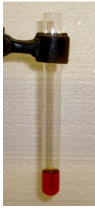
Abb. 1 - Toluol und Brom vor der Bestrahlung mit sichtbarem Licht.
