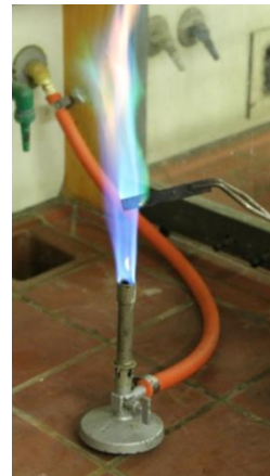
Abb. 4 - Die Beilsteinprobe ist positiv.
