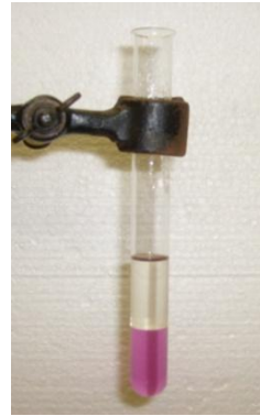
Abb. 3 - Toluol mit Baeyer-Reagenz.
