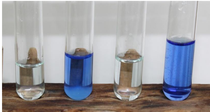
Abb. 1 - Kupfersulfatlösung (links), Kupfersulfatlösung mit Ammoniak (mitte links), nach Zugabe von Schwefelsäure (mitte rechts) und erneute Zugabe von Ammoniak (rechts).
