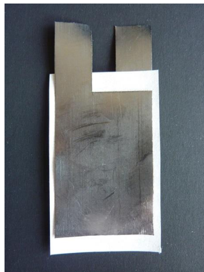
Abbildung 1: Fertiges Elektrodenmaterial mit Graphitfolie [1]
