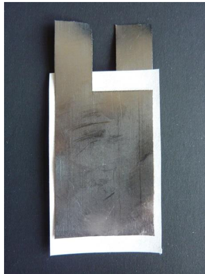
Abbildung 1: Fertiges Elektrodenmaterial mit Graphitfolie [1]
