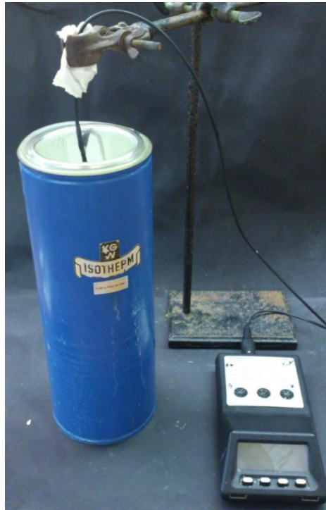
Abb.3- Aufbau zur Ermittlung der Temperaturbilanz.
