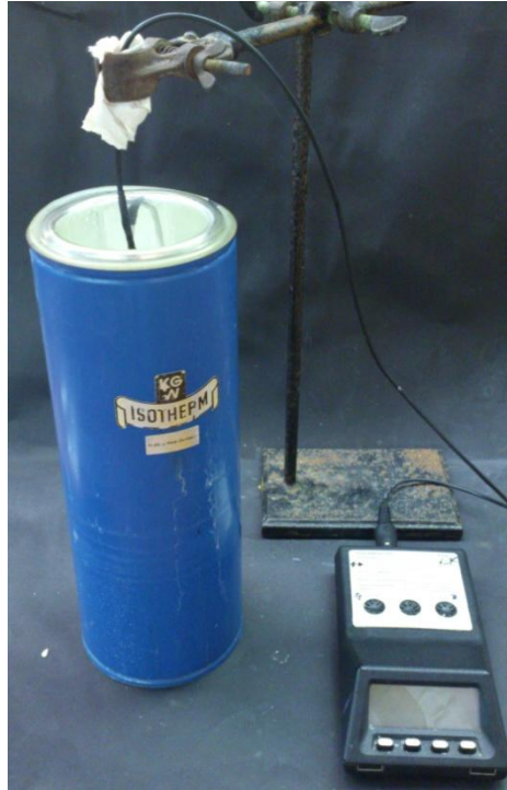
Abb.3- Aufbau zur Ermittlung der Temperaturbilanz.
