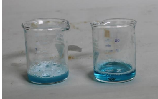
Abbildung 1. Platindraht (links) und Kupferdraht (rechts) in einer Lösung aus Methylenblau, Wasserstoffperoxid und Spülmittel
