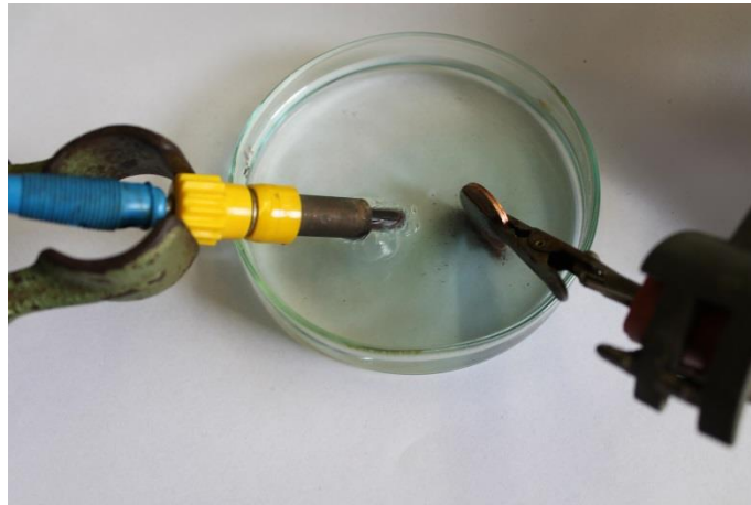
Abb. 3 - Elektrolytische Kupferraffination in Petrischale.
