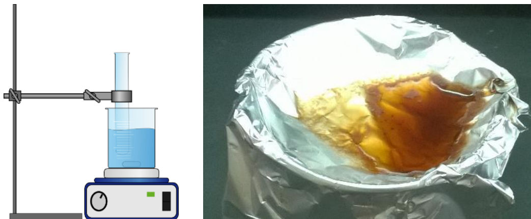
Abb. 2 – Versuchsaufbau zur Synthese von Galalith (links). Entstandenes Galalith nach aushärten (rechts).
