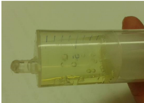
Abb. 3 - Aufstieg von Gasblasen beim Auseinanderziehen
