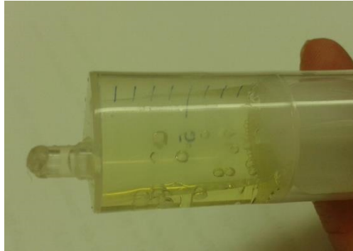
Abb. 3 - Aufstieg von Gasblasen beim Auseinanderziehen
