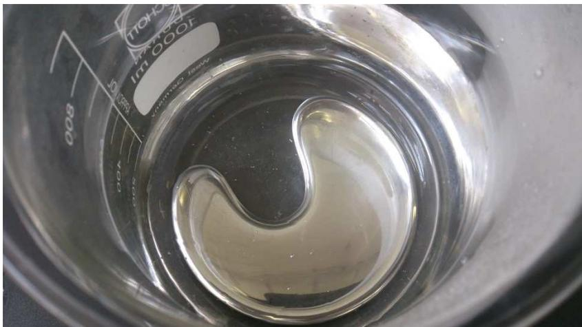
Abb. 4 - Beobachtung V2: Geschmolzenes Woodsches Metall am Boden des Becherglases.
