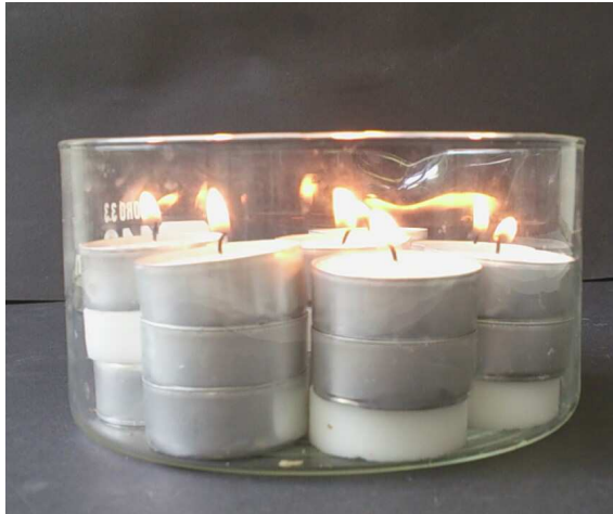
Abb. 5 – Versuchsaufbau V3: Aufbau zum Erhitzen der Proben
