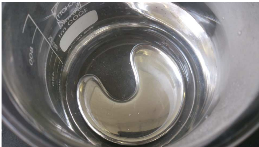
Abb. 4 - Beobachtung V2: Geschmolzenes Woodsches Metall am Boden des Becherglases.
