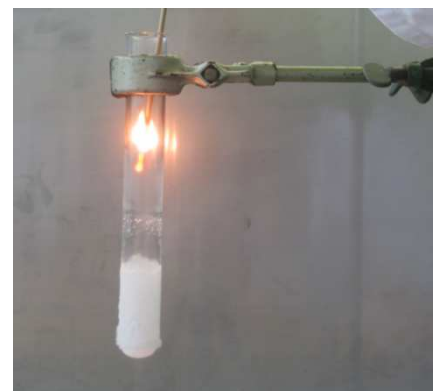
Abbildung 1 - Glimmspan nach 4 min im Duranglas mit der siedenen flüssigen Luft
