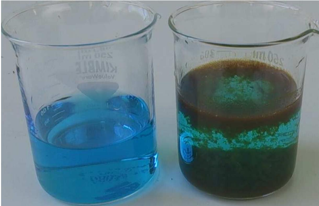
**Abbildung 1:** Bildung des Niederschlags bei der Methyleneblaulösung nach Zugabe von Eisen(III)-chloridlösung. Links: vor der Zugabe von Eisen(III)-chloridlösung; rechts: nach der Zugabe.
