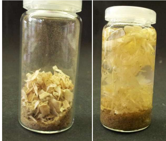
Abb. 1a - Sägespäne-Sand-Gemisch Abb. 5b – Abtrennung der Sägespäne durch Wasserzugabe
