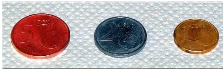
Abb. 1: Links: Münze nach der Reinigung mit Salzsäure; Mitte: Münze nach Bad in Zinkpulver; rechts: Münze nach Erhitzen in Brennerflamme.
