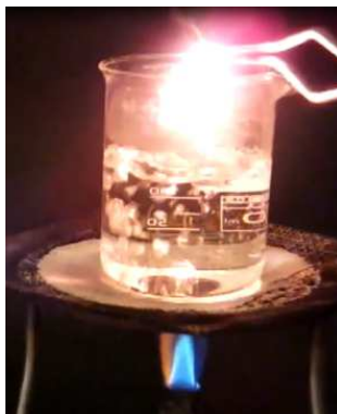
Abb 1: brennender Glimmspan (a) und brennendes Magnesiumband (b) über siedendem Wasser
