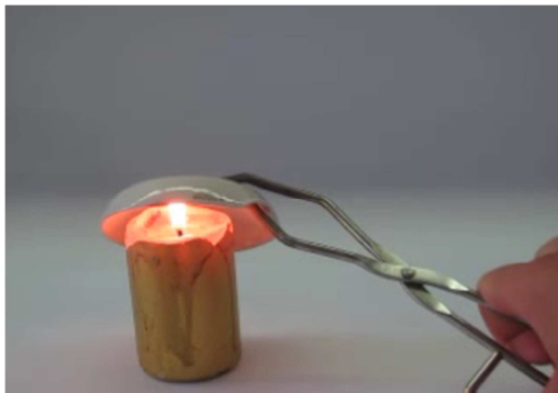
Abb. 5 – An der Porzellanschale lagert sich Ruß ab.
