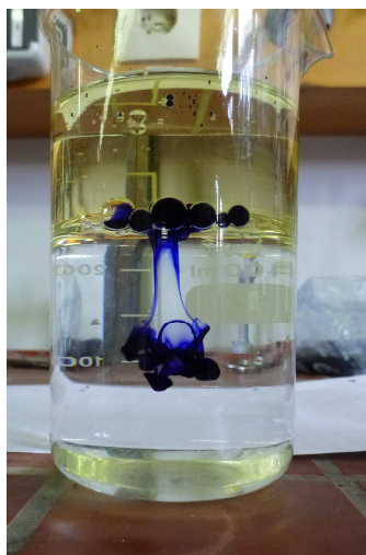
Abb. 3 - Die Tintenkügelchen platzen an der Grenzschicht auf und lösen sich im Wasser.
