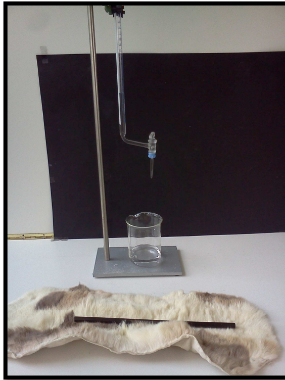
Abb. 2 – Versuchsaufbau „Der abgelenkte Wasserstrahl“
