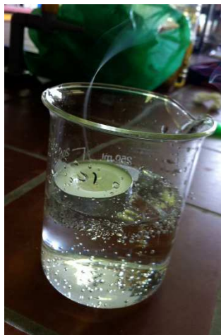
Abb. 4 – Die Kerze erlischt nachdem sie auf das Mineralwasser im Becherglas gestellt wird.
