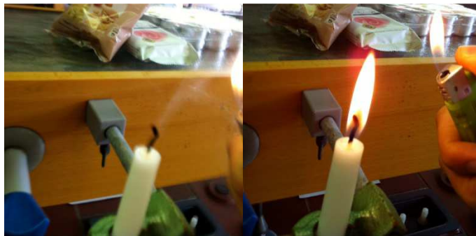
Abb. 5 – Die Kerze wird beim Halten der Feuerzeugflamme in die aufsteigenden Dämpfe entzündet.
