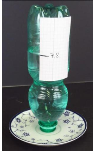
Abb. 13 - Beispiel Flaschenbarometer
