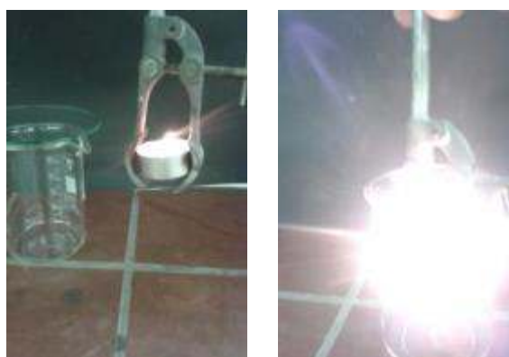
Abb.3: Verbrennung an Luft und in reinem Sauerstoff
