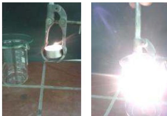
Abb.3: Verbrennung an Luft und in reinem Sauerstoff
