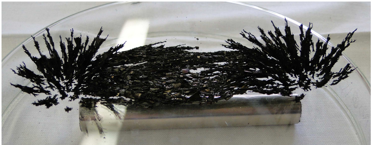
Abb. 2 - Anordnung von Eisenfeilspänen in der Nähe eines Stabmagneten
