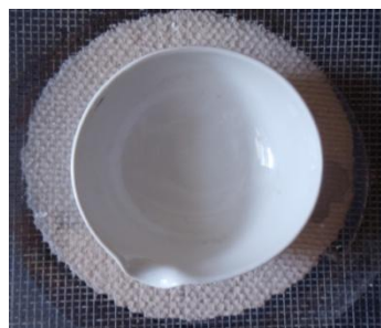
Abbildung 4: kein Rückstand in der Porzellanschale mit Wasser.
