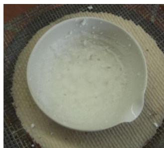
Abbildung 3: weißer, kristalliner Rückstand in der Porzellanschale mit der Lösung.
