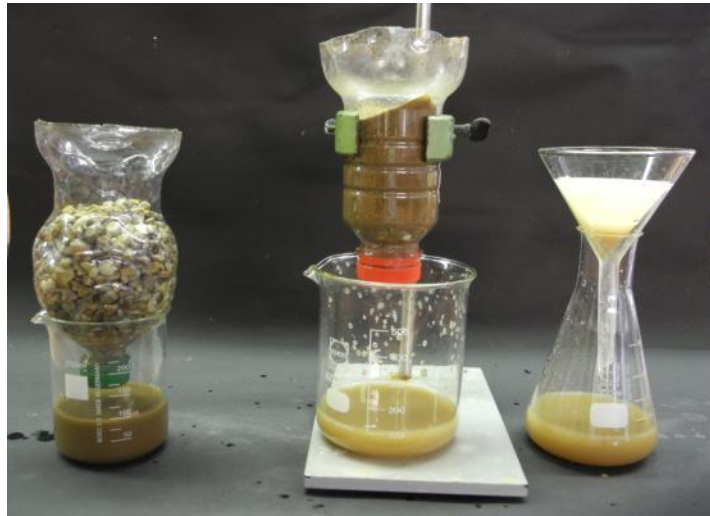
Abbildung 6: Versuchsaufbau Modellexperiment zur Kläranlage. Die verschiedenen Schritte von links nach rechts.
