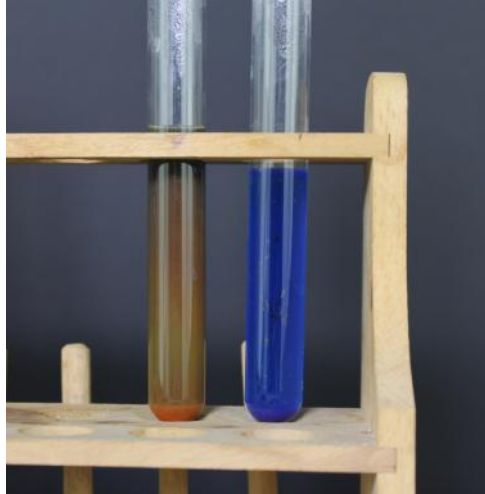
Abbildung 1: Fehlingprobe der Glucoselösung vor der biologischen Reinigung (rechts) und nach der biologischen Reinigung (links).
