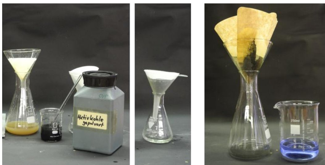
Abbildung 7: Aufschlämmung des Filtrats aus Versuchsteil b mit Aktivkohle und Filtration (links, mitte). Vergleich des Filtrats der Tintenlösung zur ursprünglichen Lösung (rechts).
