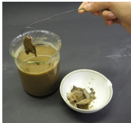
Abbildung 5: Die aufgeweichten Papierstücke werden mechanisch aus der Lösung entfernt.
