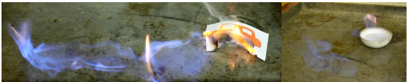
Abb.2-Das Auto, das mit n-Octan getränkt ist brennt. Wenn man das n-Octan mit Wasser versucht zu löschen, verteilt es sich auf eine größere Fläche.
