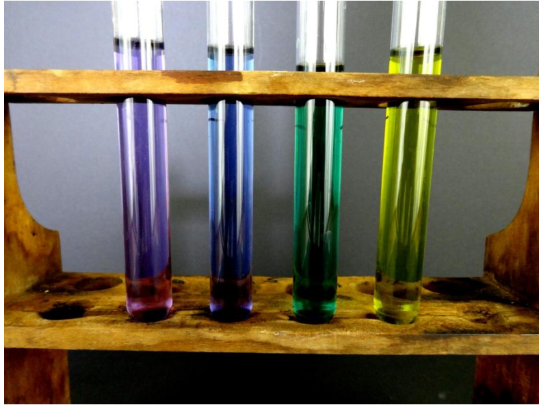
Abb. 3: Das Bild zeigt eine Verdünnungsreihe von Natronlauge mit Rotkohllindikator.
